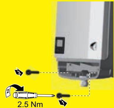
De specificaties van de fabrikant met betrekking tot levering, installatie en bedrijf moeten worden nageleefd. Volg alle installaties- en aansluitwerkzaamheden zorgvuldig volgens de normen en wettelijke voorschriften uit om mogelijke gevaren tot een minimum te beperken. De aanhaalmomenten van de betreffende aansluitingen vindt u in de gebruiksaanwijzing / installatiehandleiding van de apparaten.
