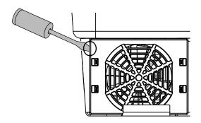
Fig. 52: Loosen fan grill
