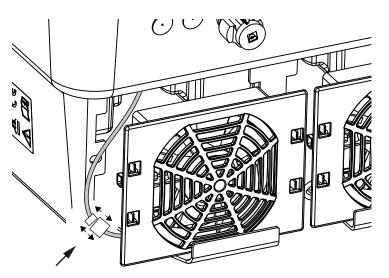
Fig. 54: Pull out fan cable
