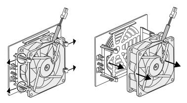
Fig. 55: Disassembly of the fan grill
